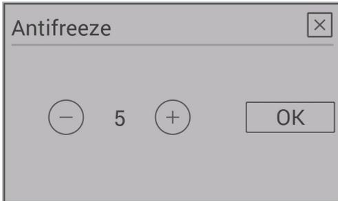
Das Frostschutz-Menü dient dazu, den Ofen bei einer vorgegebenen Temperatur automatisch zu starten. Das Menü funktioniert nur bei aktivierter Timer-Funktion (im Timer-Menü einstellen).
