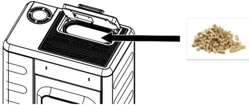
Abb. 48: Pellets füllen
