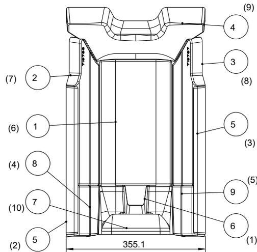
Nummerierung in der runden Klammer = Einbaureihenfolge
