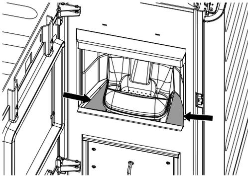
Abb. 90: Feuerraum reinigen
