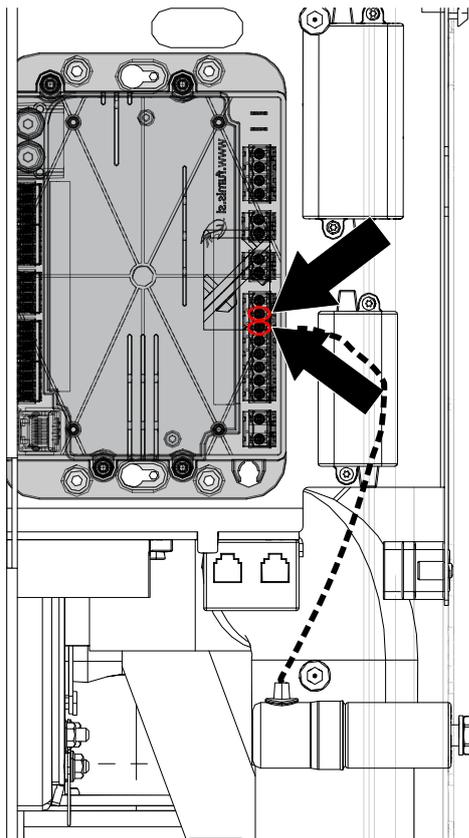
Abb. 23: Luftverteilermodul anstecken
