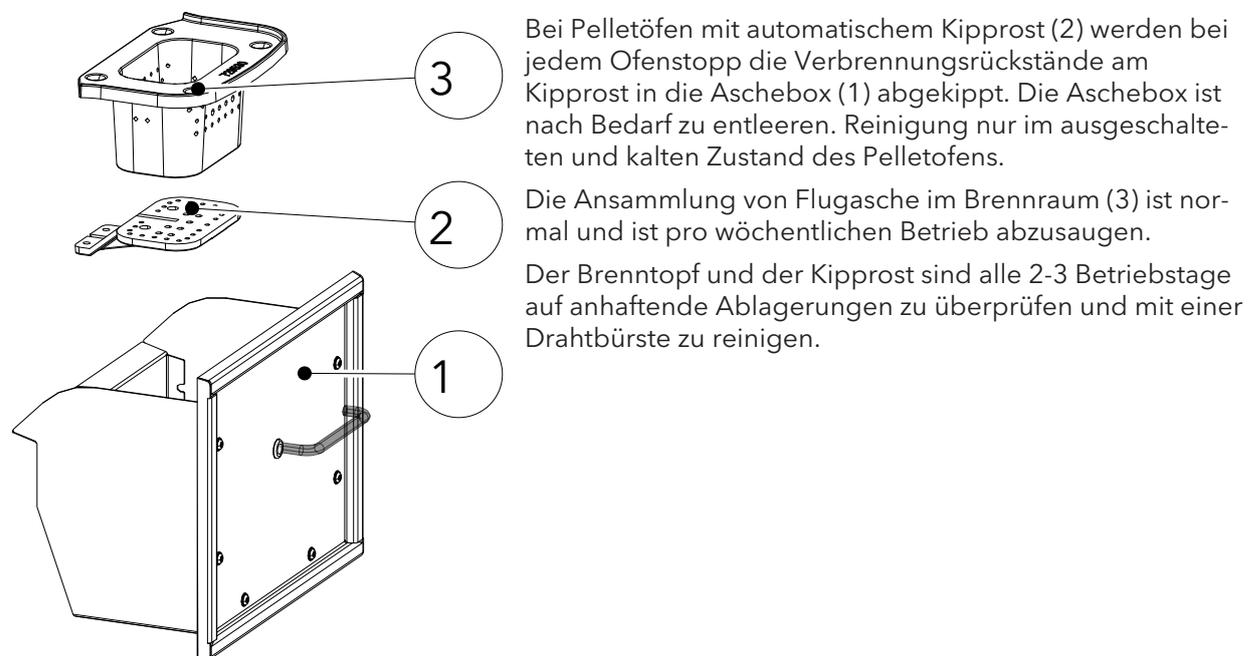
Abb. 84: Kipprost reinigen
