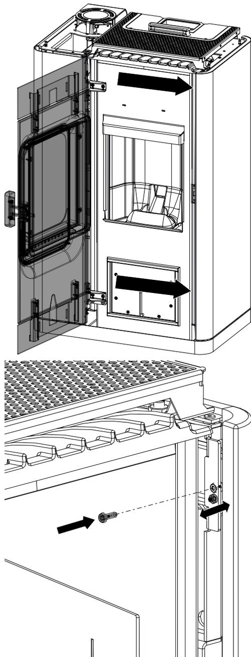
Abb. 41: Stahlverkleidung befestigen
