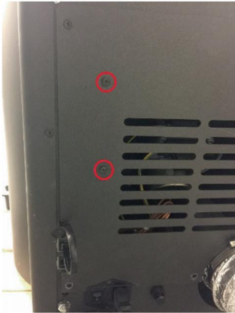
1) Auf der Rückwand des Ofens sind auf der rechten Seite 2 Bohrungen mit ISK M4 x 8 Schrauben für die Montage der WiRCU-Box vorbereitet. Diese Schrauben müssen vor der Montage mit einem 2 mm Inbus-schlüssel abgeschraubt werden.
