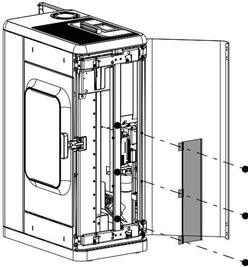
Abb. 18: Abdeckung abmontieren
