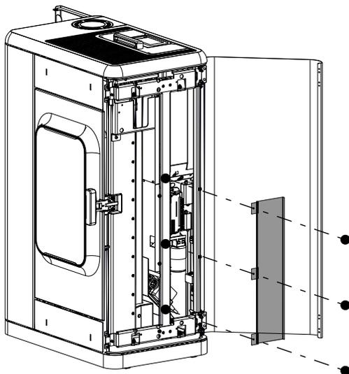
Abb. 82: Abdeckung abmontieren
