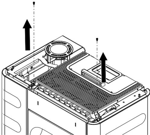
Abb. 86: Schrauben lösen
