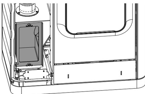
Abb. 94: Putzdeckel entfernen
