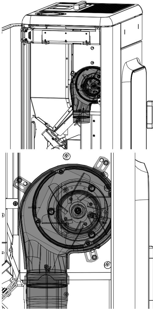
Abb. 19: Luftverteilungsmodul montieren
