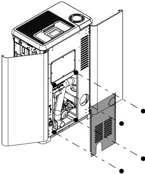
Abb. 12: Rückwand abmontieren
