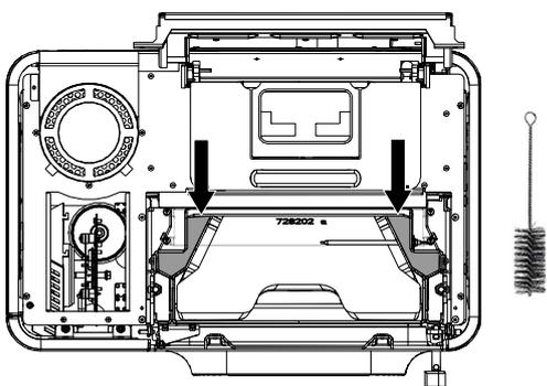
Abb. 89: Hohlraum reinigen
