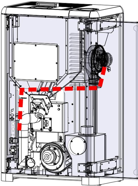
Abb. 21: Kabel durchziehen
