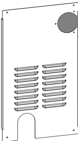
Abb. 27: perforierten Ausschnitt entfernen
