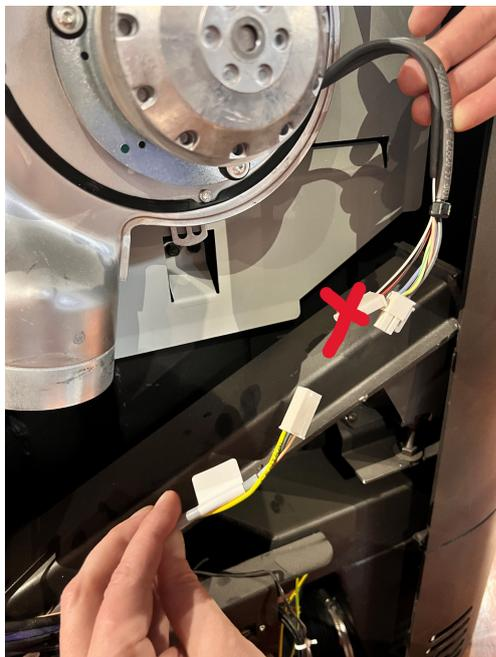
Abb. 20: Kabel verbinden
