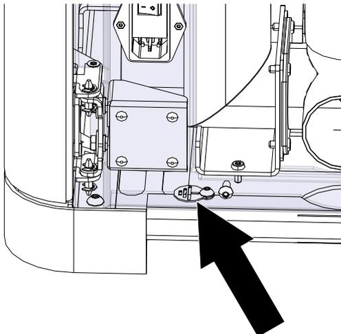
Abb. 24: Zentralerdung anschließen
