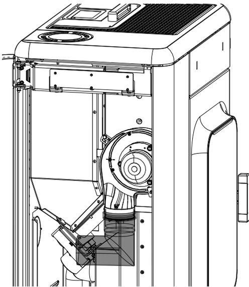
Abb. 25: Mit L-Rohrstück verbinden
