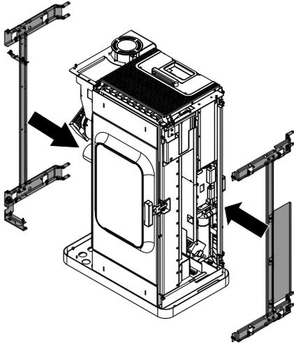
Abb. 30: Tragarme an Pelletofen anbringen
