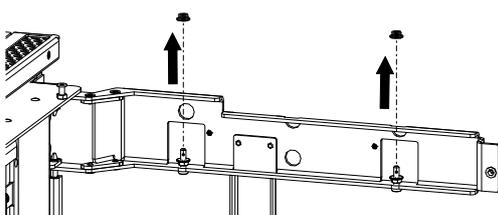
Abb. 34: Muttern lösen
