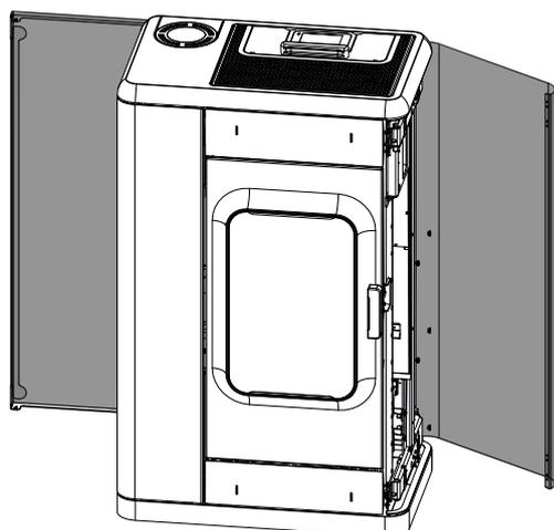
Abb. 16: Seitenverkleidung links und rechts öffnen
