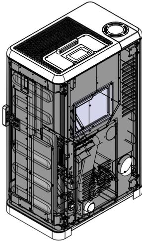
Abb. 28: Rückwand und Seitenverkleidungen montieren
