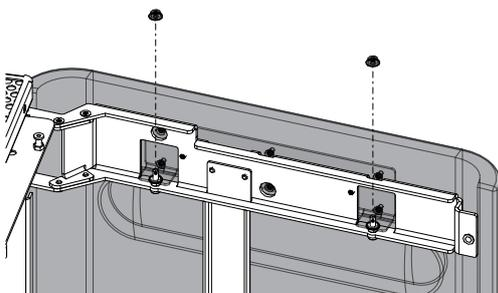
Abb. 35: Keramikverkleidung anbringen
