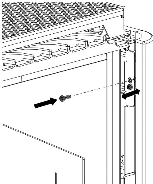
Abb. 11: Keramikverkleidung befestigen
