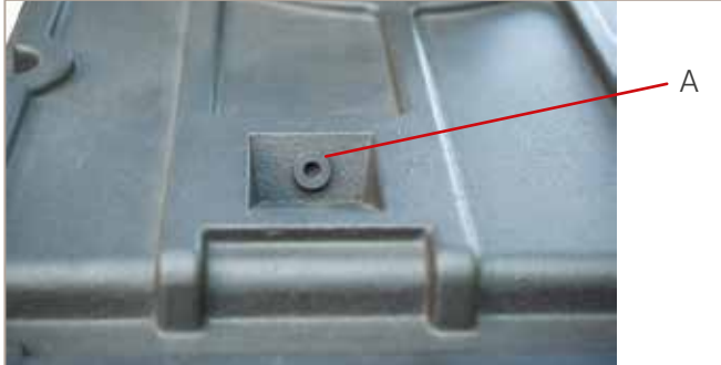
Abb. 59: Verschlussstopfen Anschlussöffnung SMR-Feuerraumfühler
