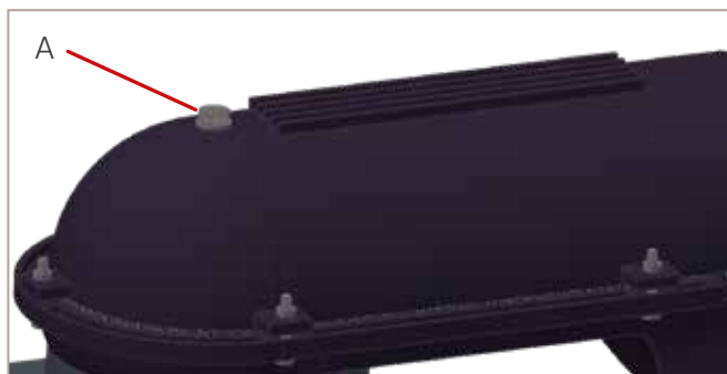
Abb. 43: waagerechter Abgang auf Abgasstutzen - Befestigung mit Sechskantschraube
