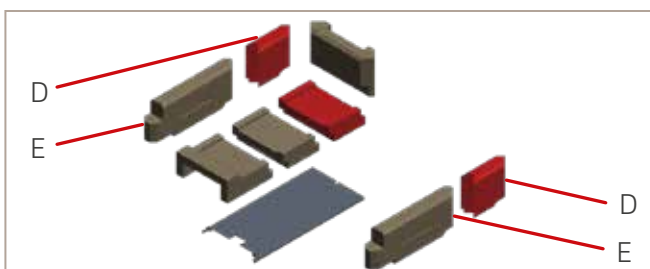
Abb. 32: Ausbau Bauteile D, E,
