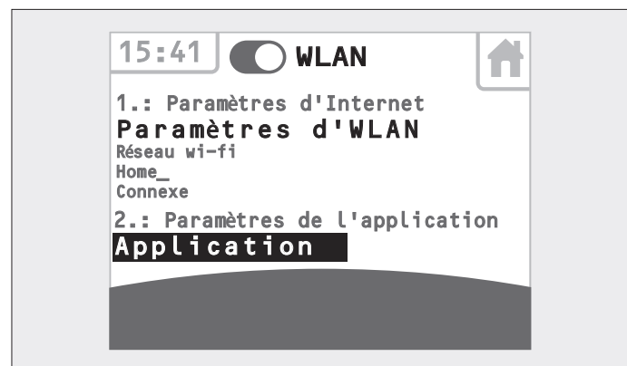
Fig. 3.33 Panneau de commande tactile – Accès au Wi-fi activé
